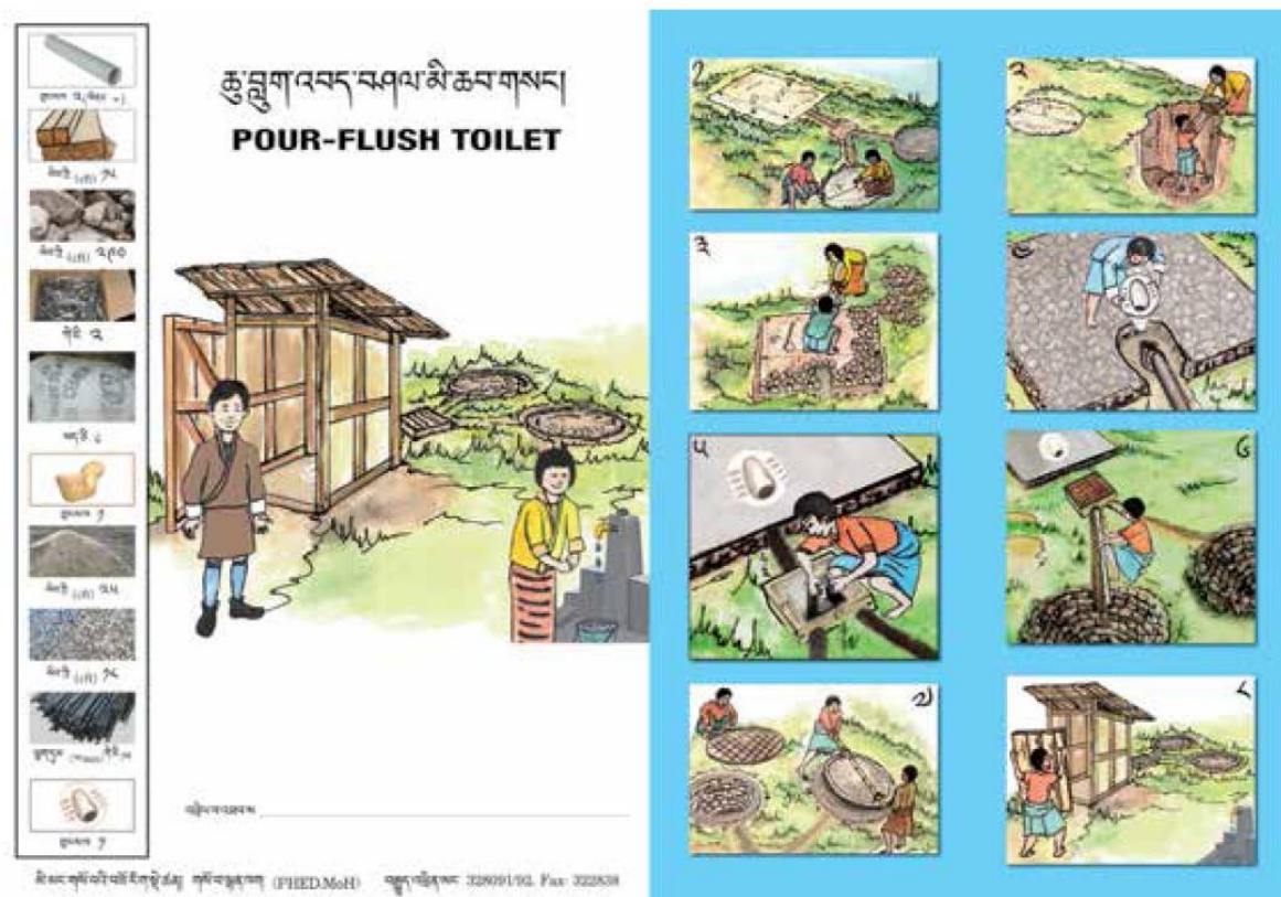
Figure VI-12 Construction step for Pour Flush Toilet
